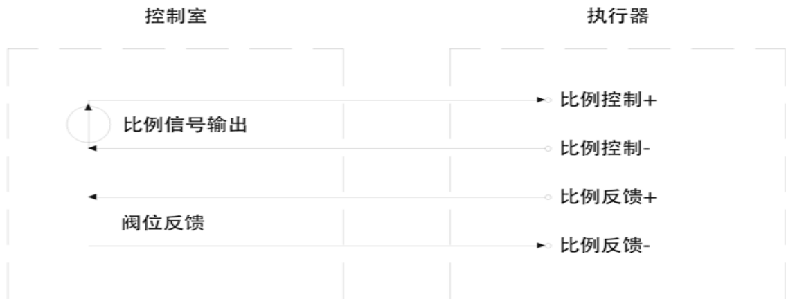
图7-16 远方自动控制反馈接线示意 (高级设置内调节控制需设置为允许)
